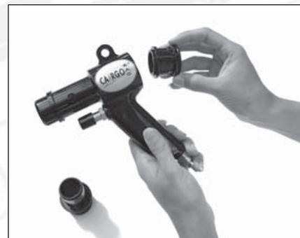
3. Ziehen Sie den schwarzen Insert und die zwei O-Ringe aus dem Pistole.
