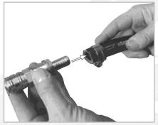
Glissez le "Quick coupling hose pillar" dans le tuyau.
