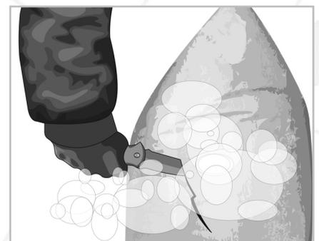
9. Entleeren: Stecken Sie der Stausack durch für entleerung und nehmen Sie der Stausack heraus.
