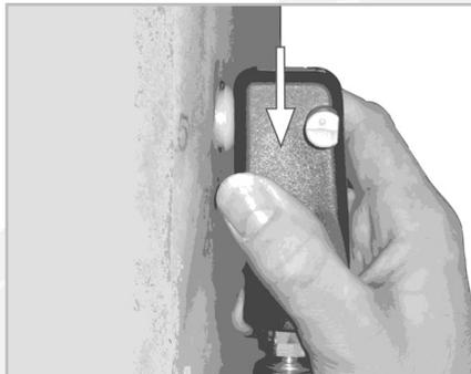
2. Positionieren Sie der MouseTip und schieben Sie der MouseTip über dem Ventil.
